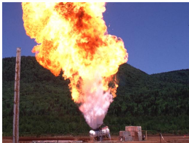
Boiling Liquid Expanding Vapor Explosion (BLEVE)
